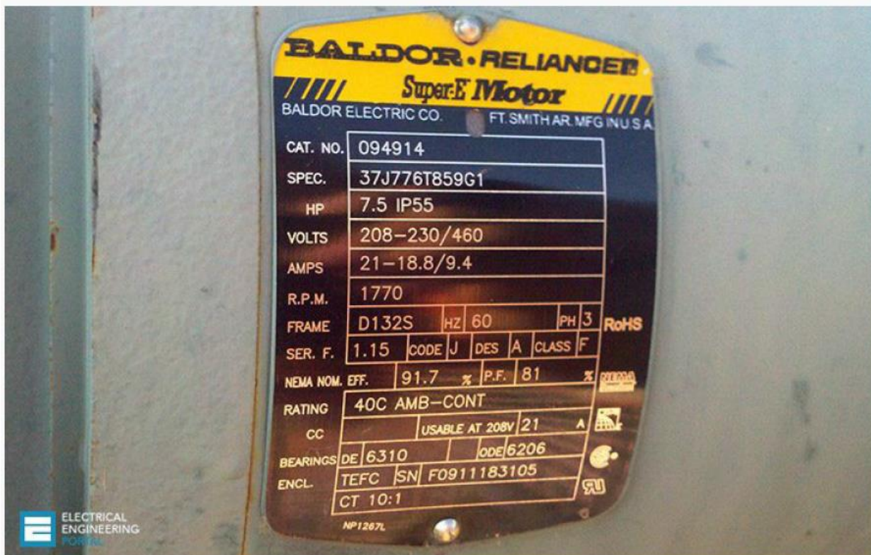
HÌNH PL2.2: Mẫu nhãn máy (name plate) động cơ 3 pha cảm ứng có đầy đủ các thông số.
