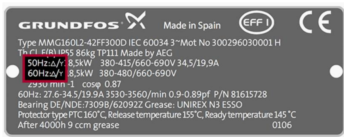
HÌNH PL2.7: Thông số điện ghi bổ sung trên nhãn máy khi động cơ có thể vận hành 2 cấp tần số.
