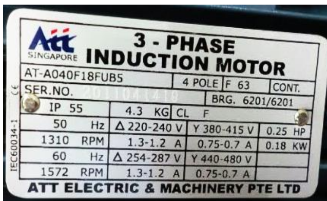
HÌNH PL2.1: Một số dạng nhãn máy (name plate) của các động cơ 3 pha cảm ứng.
